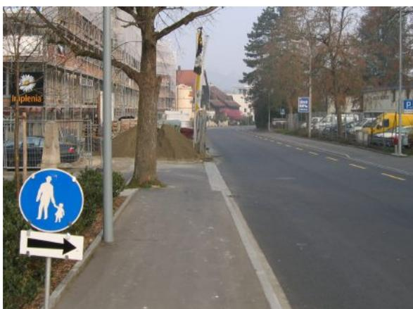
Améliorable: l'interruption du trottoir est certes indiquée, mais il n'existe pas de mesures de remplacement. La création d'un cheminement au détriment de la chaussée serait en principe possible.
