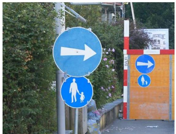
Améliorable: il s'agit du mauvais signal. La flèche bleue n'est valable que pour les véhicules. De plus, les signaux provisoires provoquent un danger pour les personnes malvoyantes.
