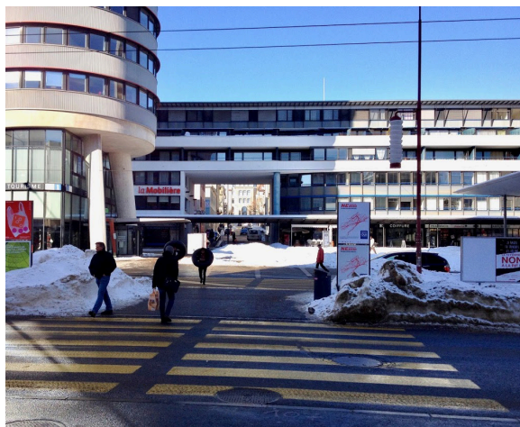
Illustration 3 : Les talus de neige doivent s'interrompre aux passages piétons et autres points de traversée.
