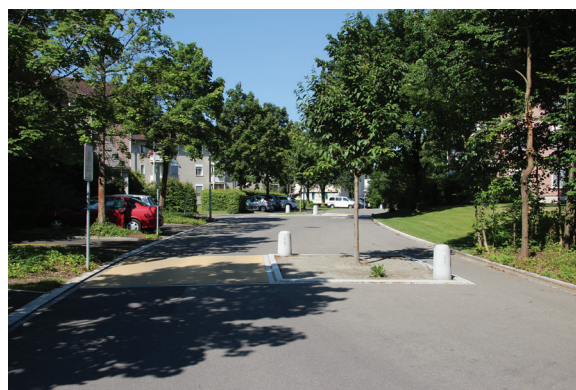
Route de desserte avec un arbre servant de modérateur de vitesse, Erlenbach ZH
