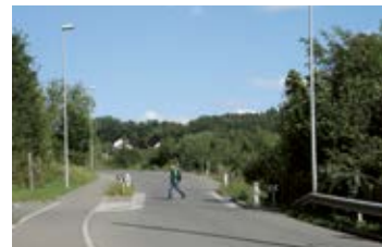
Le rétrécissement bilatéral augmente la distance de visibilité et sécurise la traversée.
