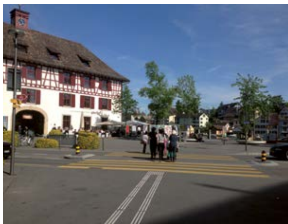
Les lignes de guidage mènent les personnes aveugles ou malvoyantes au passage piéton.
