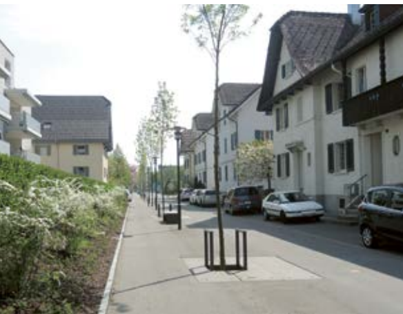
Séparation douce entre l'espace piéton et la chaussée au moyen d'arbres, d'éclairage et de bancs publics dans une zone de rencontre.
