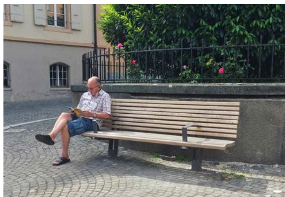
Illustration 4. Accoudoirs intégrés au banc « Lausanne » développé spécifiquement pour les PMR et les rues en pente (Ville de Lausanne).
