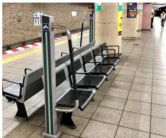
Illustration 10. Une barre aide à se relever, elle pourrait néanmoins être davantage intégrée au design.
