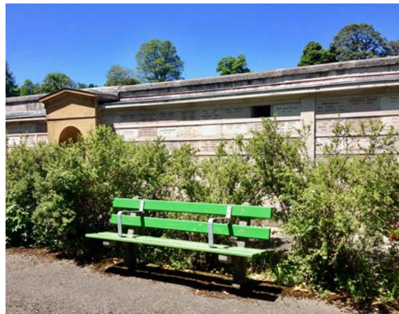
Illustration 5. Banc dont les accoudoirs ont été ajoutés pour aider à se relever dans le parc d'un cimetière. La solution retenue empêche de se coucher.
