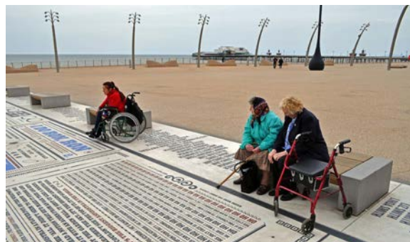
Illustration 9. Espace suffisant proche du banc et accès plain pied pour utiliser le banc avec un fauteuil roulant ou un déambulateur. Les appuis pour le dos et pour se relever font défaut (Community Archive CC BY Flickr).
