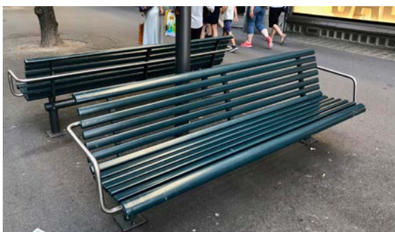
Illustration 47. Très robustes, les accoudoirs des bancs de la Ville de Zurich ont un rôle de protection contre les véhicules béliers.
