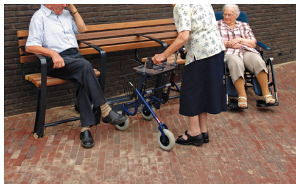
Illustration 11. Les bancs adaptés aux personnes âgées tiennent compte des besoins ergonomiques et facilitent le mouvement pour se relever. Le modèle Vivanti (velopa.de) permet à une personne avec un déambulateur de s'appuyer au dossier, cette place n'est cependant pas utilisable par d'autres usagers.
