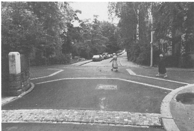
Fig. 5-5: Exemple de pavage et d'élargissement du trottoir
