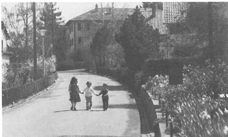
Fig. 5-2: Un trottoir impièterait de façon significative sur les jardins; on a donc conservé à la rue une "utilisation combinée" par les piétons et les véhicules.
