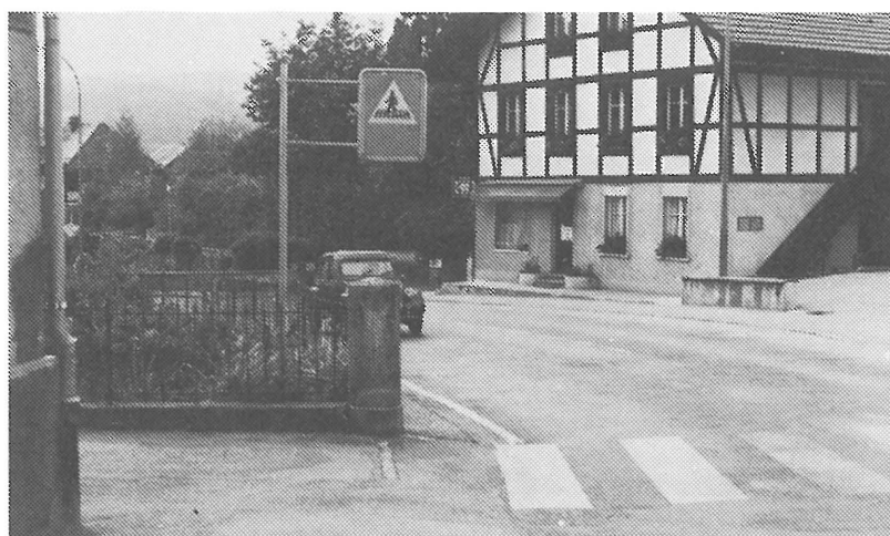
Fig. 7-1: Visibilité de la chaussée insuffisante pour le piéton
