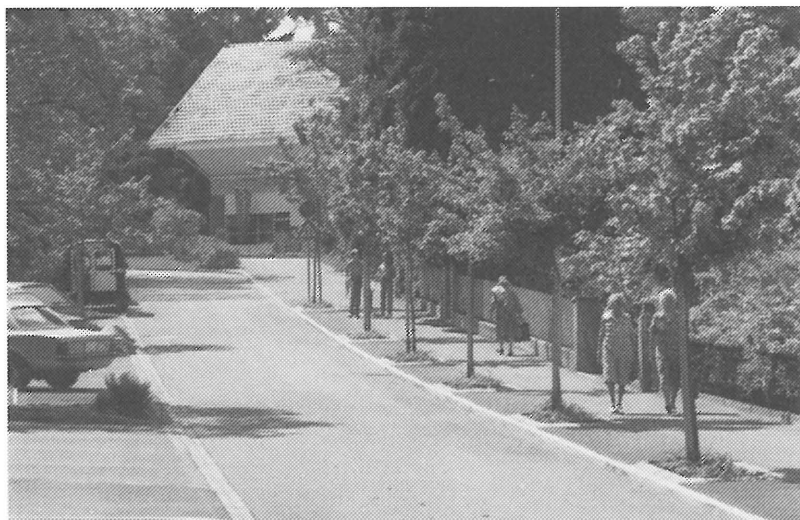
Fig. 7-6: Une allée d'arbres sépare le trottoir de la chaussée
