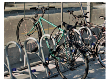
Les rails et les systèmes de fixation par la pédale permettent d'attacher le cycle et d'éviter qu'il ne tombe.
