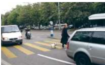
Le passage piéton n'est pas sécurisé alors qu'il traverse deux voies de circulation allant dans le même sens.
